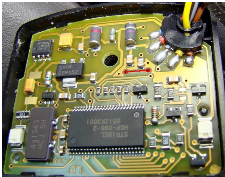
Abbildung 3: Anschlusspunkt (rot) für die MG Steuerleitung (braun, nicht im Bild dargestellt)
