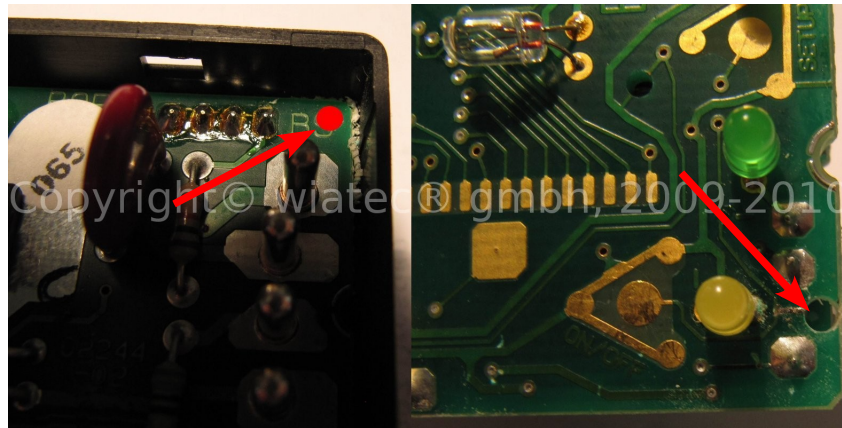
Abbildung 2: Links - Loch ( \phi 2.5mm) an der rückseitigen, rechts – n der frontseitigen Platine zum Durchschleifen der Steuerleitung.
