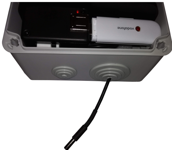
Abbildung 2: Aufbau des MicroGuard-USB Systems zur Bodenfrostdüberwachung, innen-liegendes Alarmmodul
