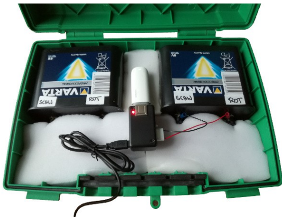
Abbildung 1: Aufbau des MicroGuard-USB Systems zur Bodenfrostüberwachung
