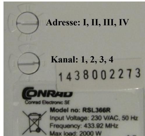
Der PLUGCODE setzt sich zusammen aus dem Adress-Code, dem Kanal-Code und den Ziffern „00“. Der Adress-Code aus römischen Ziffern I, II, III oder IV und der Kanal-Code aus arabischen Ziffern 1, 2, 3 oder 4 sind an der Steckdose einzustellen bzw. von dort abzulesen. Der aus Tabelle unten resultierende PLUGCODE bitte unter MG PLUGCODE im Telefonbuch eintragen und in SMS-Befehlen entsprechend verwenden. Beispiel: Einstellung mit **Adresse III** und **Kanal 2** hat den PLUGCODE **0010010000**.
