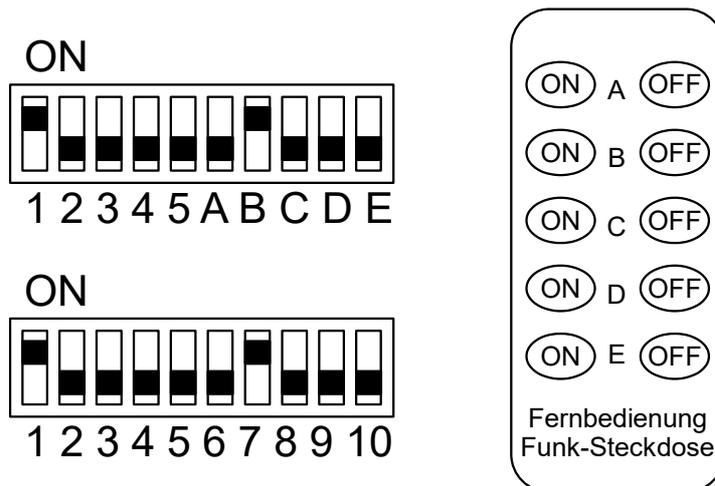
Abbildung 1: Hauscode und Gerätecode an der Funk-Steckdose
